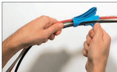
1) Junte todos los cables e insértelos en la herramienta de aplicación.
