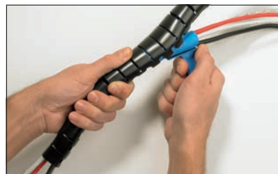
3) Tire de la herramienta de aplicación para que los cables queden dentro del Helawrap.
