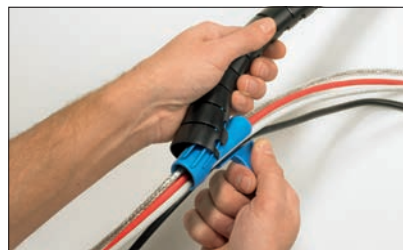
2) Coloque el Helawrap en la herramienta de aplicación.
