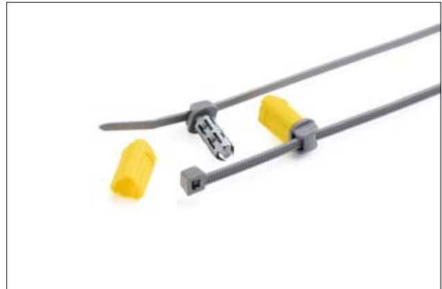
T50RDHA8.4x20-PA46 适用于盲孔应用和温度要求较高的场合，包含运输盖，用于在运输过程中保护线束。
